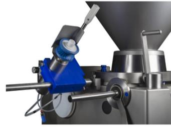
Il passaggio dell'insacco in continuo al processo di attorcigliatura avviene rapidamente e senza attrezzi.
