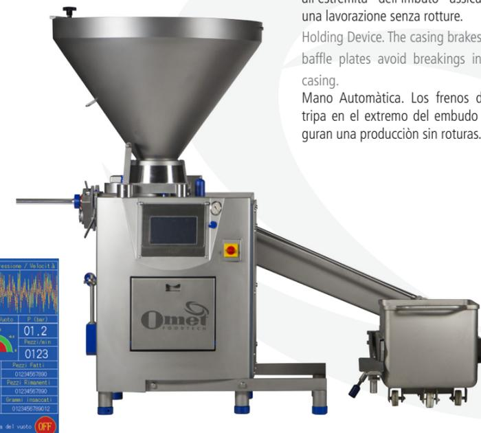
L'Insaccatrice continua sottovuoto **F9** è una macchina compatta ideale per l'artigianato e per la piccola impresa. La Pompa di insacco a palette di piccolo diametro può essere dotata di 8 o 12 palette.
