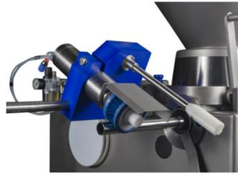
L'Arricciatore permette di incrementare la produttività dell'operatore quando viene usato budello naturale. Un motore pneumatico consente di infilare rapidamente negli imbusti d'insacco tutti i budelli naturali senza danneggiarli.
